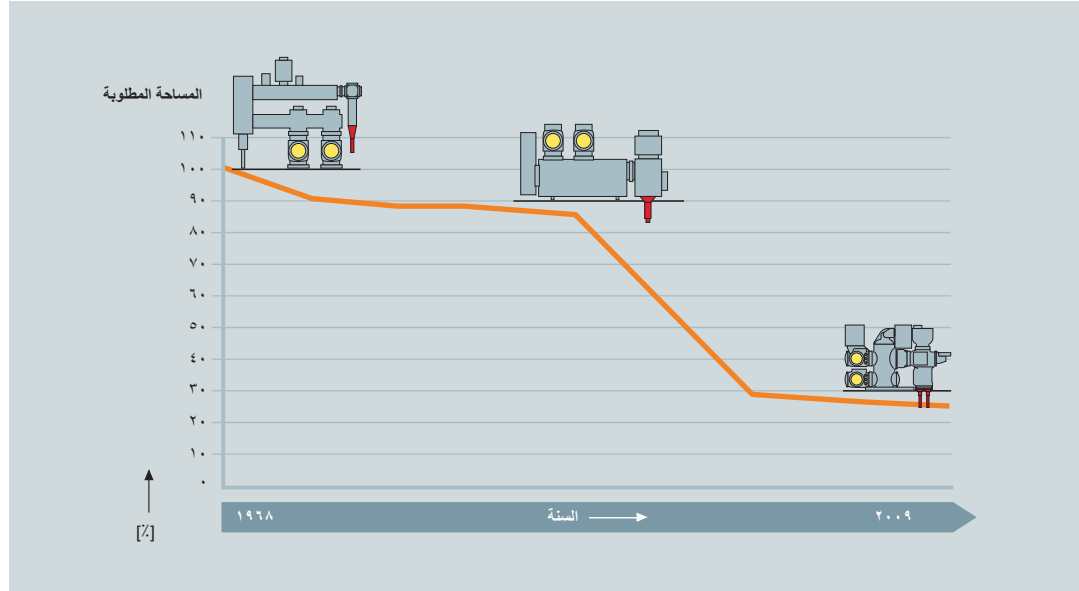
عمل التطوير المستمر على تقليل الحيز المطلوب للقاطع الكهربائي المعزول بالغاز بجهد ١٤٥ كيلو فولت إلى ٢٥٪ فقط من التصميمات الأولى في عام ١٩٦٨
